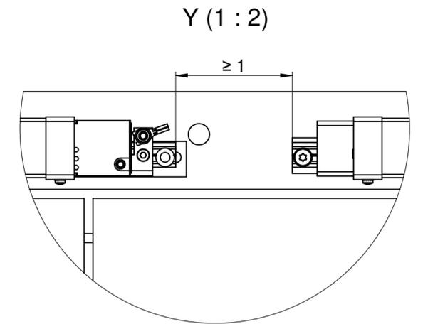
Darstellung ohne Mittelabdeckung sowie Verbindungsstange und Kabel
