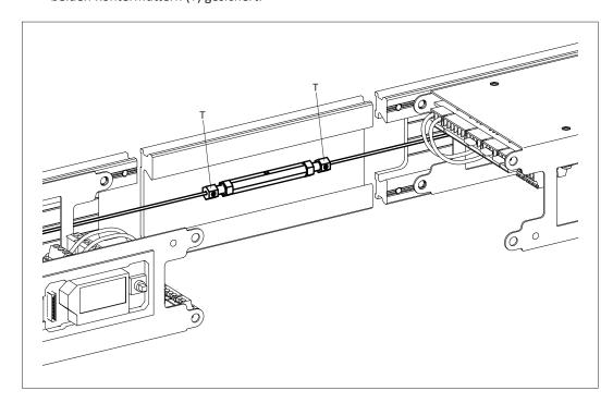
4. Durch Herausdrehen des Positionierstabes (E) beim SECONDARY-Antrieb kann das Drahtseil ebenfalls noch nachgespannt werden. Dazu den Gewindestift (M) leicht lösen und Positionierstab (E) von Hand oder mittels Schlitzschraubendreher herausdrehen. Anschliessend Gewindestift (M) wieder fixieren ⇒ Anzugsdrehmoment max. 0,5 Nm.
