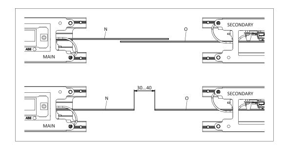
3. Bowdenzughüllen über die Drahtseile schieben. Bei Bedarf die Bowdenzughüllen mit einem Seitenschneider kürzen.
