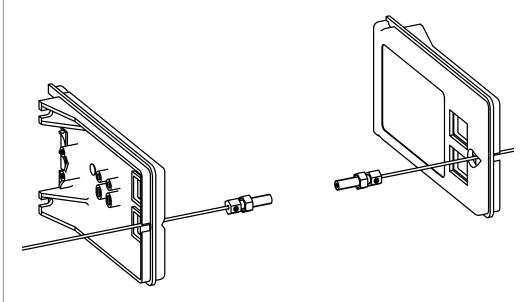
6. Eine der Drahtseilklemmen (Q) leicht in die Spannschlossmutter (S) eindrehen (ca. 3...4 Umdrehungen), anschliessend den Vorgang mit der zweiten Seilklemme am anderen Ende der Spannschlossmutter (S) wiederholen.
