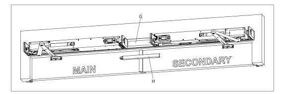
10. Zubehörelemente (wie z.B. Öffnungselemente, Sicherheitssensoren, Brandmelder usw.) montieren und gemäss Schaltschema anschliessen.
